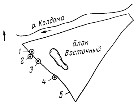
РИС. 13.5. Расположение шахтных стволов 1, 2, 3, 4 на руднике Таштагол относительно границы подвижного блока (5)
