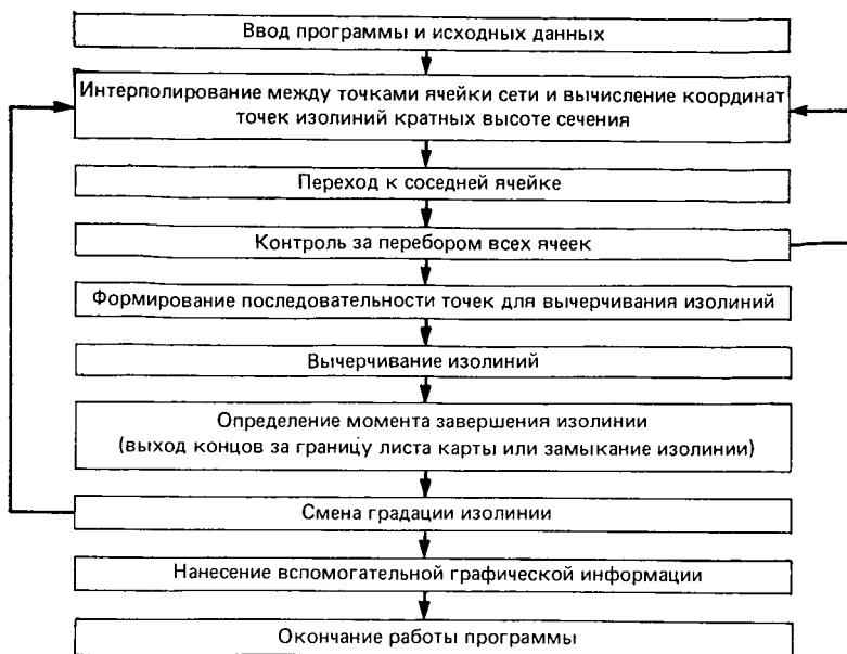
РИС. 8.6. Краткая блок-схема программы построения изолиний на графопостроителе
