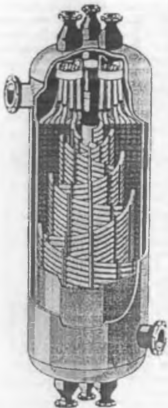
Рис. 3.16. Теплообменный кожухотрубчатый витой испаритель-конденсатор СПГ
