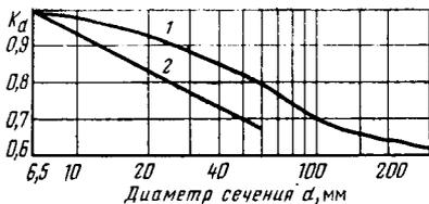
Рис. III.5. График для определения коэффициента влияния абсолютных размеров сечения: 1 — углеродистая сталь; 2 — легированная сталь
