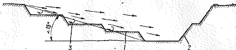
Рис. 7.9. Прямоточная схема проветривания карьера с помощью энергии ветра:
