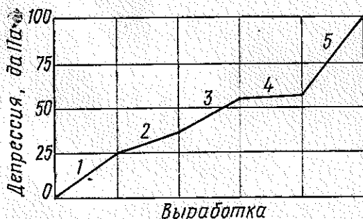
Рис. 6.23. Депрессиограмма шахты: 1, 2, 3, 4, 5 — потеря напора в стволе, квершлагае, штреке, лаве и вентиляционном штреке соответственно
