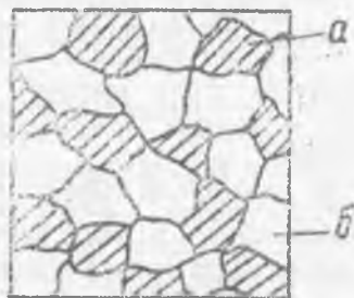
5. 4-rasm. Mexanik aralashmaning mikroskopik tuzilishi. (sxemasi) a - A komponent kristallari, b - V komponent kristallari
