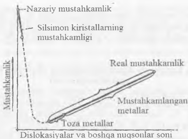
10. 1-rasm. Dislokatsiya va nuqsonlarning metall mustahkamligiga ta'siri
