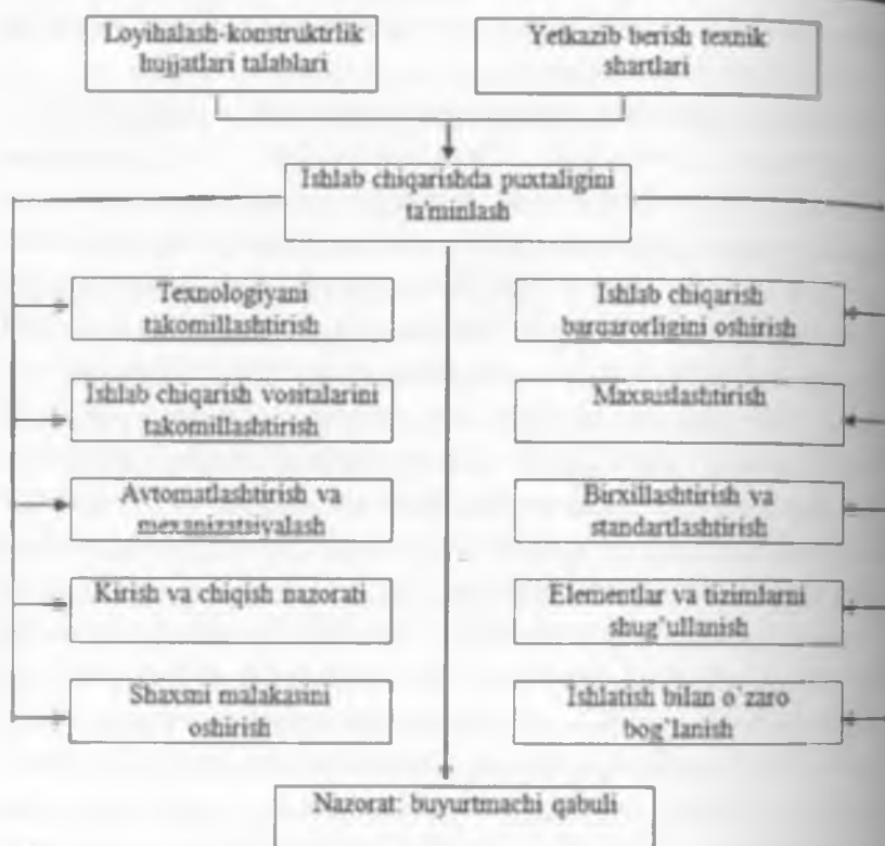
3.3.1-rasm. Ishlab chiqarishda jihozning puxtaligini ta'minlash bo'yicha tadbirlar strukturasi
