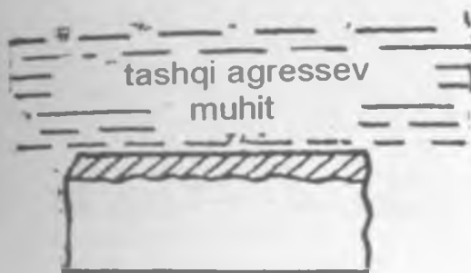
6.1.1-rasm, a) tekis korroziya
