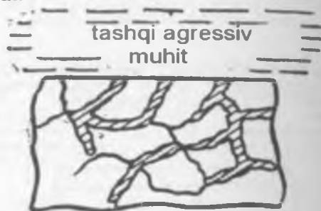
6.1.1-rasm, v) kristallitlararo korroziya
