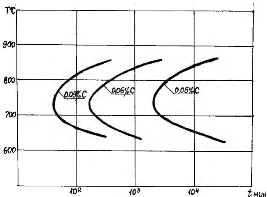
5.13.3-rasm. Metalldagi uglerod miqdorining kristallararo korroziyaga va isitish davomiyligiga ta’siri.
