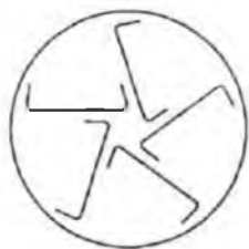
5-rasm. Tegirmon oxirgi bo'lmasining radial to'siqlari sxemasi.
