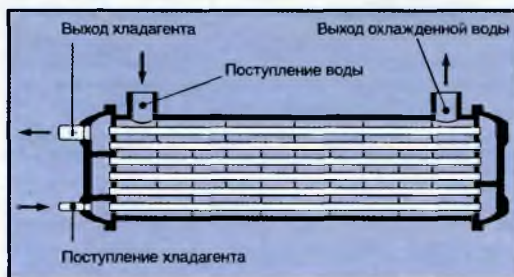
Рис. III.21. Схема кожухотрубного испарителя
