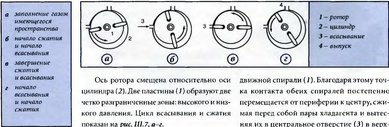
Рис. III.7. Ротационный компрессор с двумя подвижными пластинами
