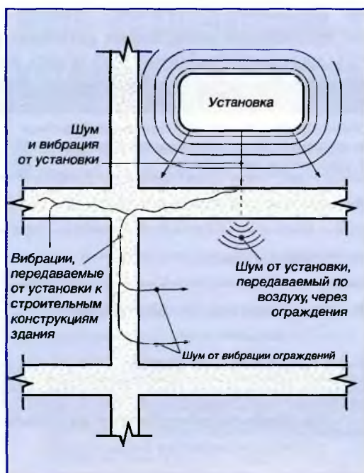
Рис. V.16 Направления распространения шума по воздуху, через несущие конструкции в виде вибрации, либо через контакт с полом
