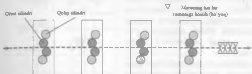
17.2.3-rasm. Matoning yuz va orqa tomonini to'rt rangda bosish uchun bosma seksiyalar konfiguratsiyasi; matoni gorizontal uzatish uchun bosma seksiyalar (IFRA)
