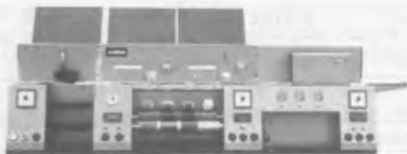
13.4.1-rasm. Ko'p maqsadli namuna bosadigan mashina. Chap tomonda modul sifatida ho'llovchi uskuna, o'ng tomonda esa issiq havo bilan quritish qurilmasi joylashgan. Sinov bosma bichimi: kengligi 40 mm va uzunligi 200 mm. Testlarni 0,1 dan 12 m/s gacha bo'lgan bosma tezliklarida bajarish mumkin. Qisqich bosimi va bosma ketma-ketligi intervali o'zgaruvchan (prufbau Dr. Durner GmbH firmasi)
