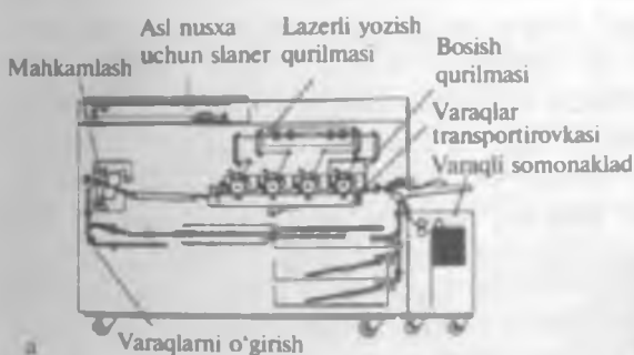
4.1.6-rasm To'rt rangli bosma tizimi (NIP texnologiyasi: elektrofotografiya): a — naklad sxemasi;
