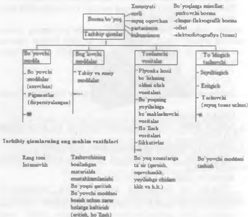
14.1.1-rasm. Bosma bo'yoqning tarkibiy qismlari
