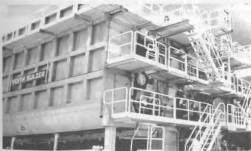
13.2.1-rasm. Dunyoda eng unumli qog'oz ishlab chiqaruvchi mashina (Voith Sulzer Paper Technology, Germaniya, 1997): a – ishlab chiqarish bosqichlari sxemasi; b – mashinaning tashqi ko'rinishi, mato vazni 40 dan 50 g/m 2 gacha, mato kengligi 9 m, tezlik 28 m/s, ishlab chiqarish quvvati 190000 t/yiliga, qog'oz ruloni vazni 60 t
