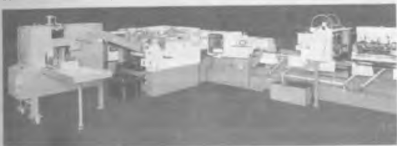
5.1.3-rasm. Broshyuralar tayyorlash uchun falslangan varaqlarni yig'ish va ularni keyingi qayta ishlash (Prosettter 562, Heidelberg)
