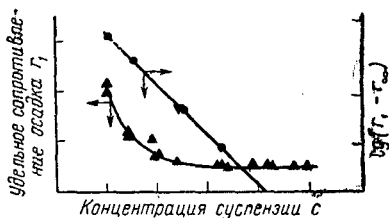
Рис. III-3. Зависимость удельного сопротивления осадка от концентрации при разделении малоконцентрированных суспензий.
