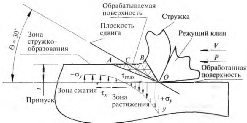
Рис. 1.2. Схема резания
