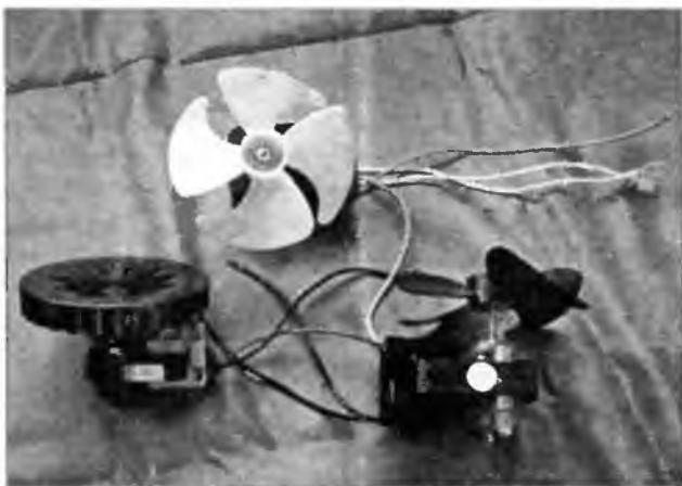
Рис. 1.11. Внешний вид вентиляторов системы «No Frost»
