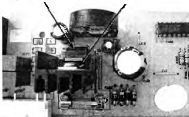
Рис. 6.2. Расположение микросхем стабилизаторов напряжения на плате электронного модуля
