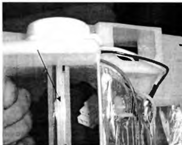
Рис. 6.8. Внешний вид воздушной заслонки в открытом состоянии
