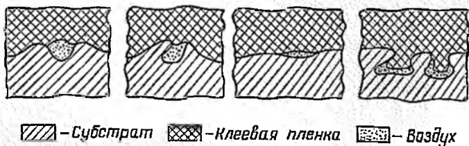
Рис. 1.3. Возможные варианты заполнения клеем микрорельефа поверхности склеиваемой детали
