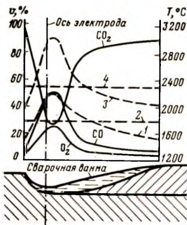
Рис. 79. ИЗМЕНЕНИЯ СОСТАВА ГАЗА v ПО ОСИ СВАРОЧНОЙ ВАННЫ И ТЕМПЕРАТУРЫ T В ЗОНЕ СВАРКИ:
