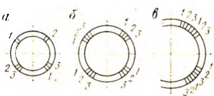
Рис. 162. СХЕМА ВЫРЕЗКИ ОБРАЗЦОВ ДЛЯ МЕХАНИЧЕСКИХ ИСПЫТАНИЙ НА РАСТЯЖЕНИЕ (1), НА ИЗГИБ КОРНЕМ ШВА НАРУЖУ (2), НА ИЗГИБ КОРНЕМ ШВА ВНУТРИ (3) ДЛЯ ТРУБ ДИАМЕТРОМ ДО 400 ММ (а), ОТ 400 ДО 1000 ММ (б) И БОЛЕЕ 1000 ММ (в)
