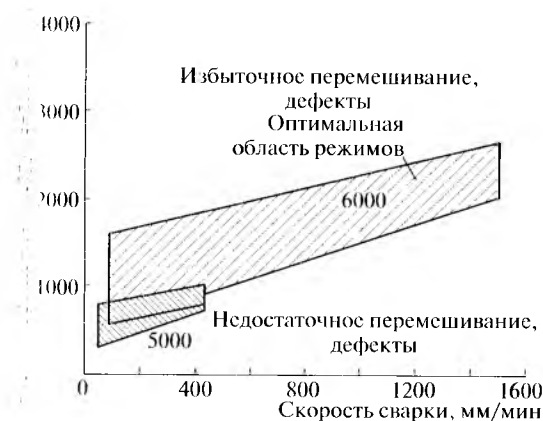
Рис. 5.29. Соотношение скорости сварки и частоты вращения инструмента, позволяющее получать качественные соединения алюминиевых сплавов серий 5000 и 6000
