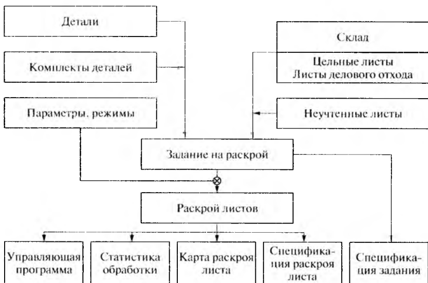
Р и с. 7.86. Схема работы программы «Раскрой листового материала»
