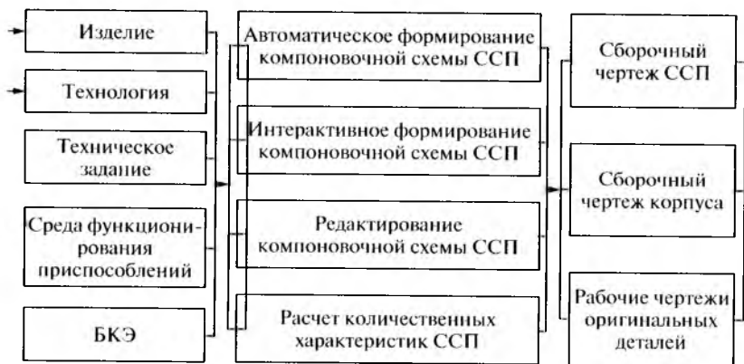
Рис. 7.88. Схема построения системы ИНСВАР для автоматизированного проектирования сборочно-сварочной технологической оснастки
