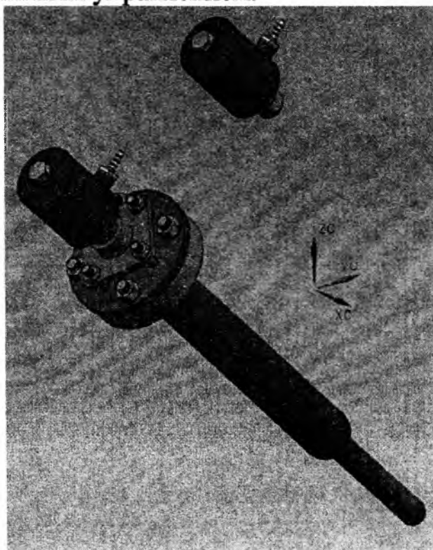
Рис. 13.2. Трехмерная модель первичного преобразователя расходомерного устройства
