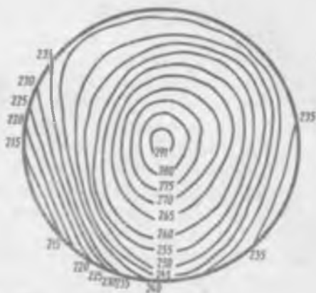
Рис. 9.8. Изотерма жарочной поверхности электрической сковороды СНЭ-0,2
