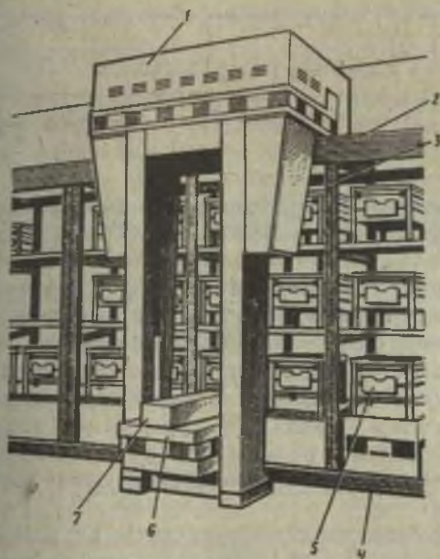
10.25- расм. Штабелёр-роботли автоматлаштирилган токча-тўплагич: 1 — штабелёр-робот; 2 — устки рельсли йўл; 3 — катакчали токча; 4 — қўйи рельсли йўл; 5 — токчанинг катакчасида жойлашган идиш; 6 — каретка; 7 — телескопик стол
