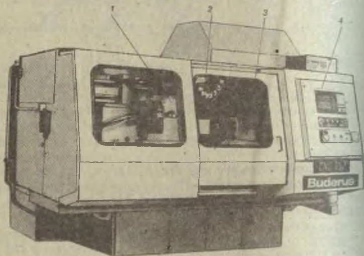
8.16-расм. BUDERUS фирмасининг (Германия) CNC352IUG модели СДБ кўпоперацияли силлиқлаш станогни (ички ва ташқи сиртларни силлиқлаш учун мўлжалланган);
