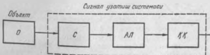
70- расм. Масофадан туриб ўлчаш системасининг функционал схемаси.
