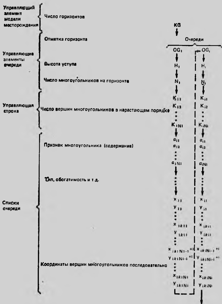
Рис. 4.12. Структура последовательного файла, созданного по принципу очереди
