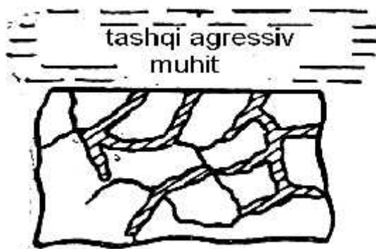
14-rasm, v) kristallitlararo korroziya.
