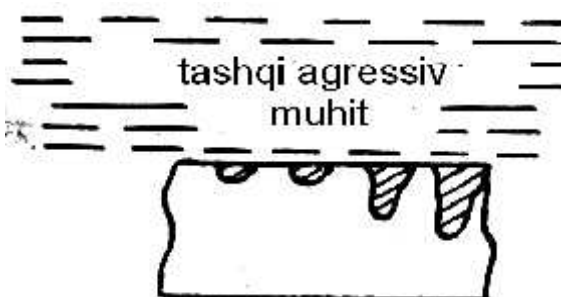
14-rasm, b) mahalliy korroziya.
