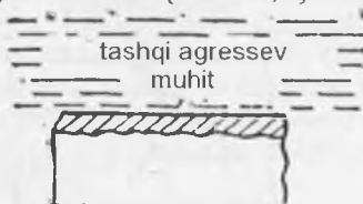
14-rasm, a ) tekis korroziya.
