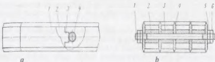
54-rasm. Tutashtirgichni keskich pichog'i bilan payvandlab (a) va rezkali (b) biriktirish sxemasi.
