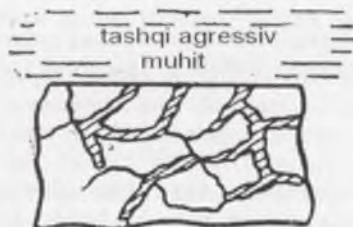
14-rasm, v) kristallitlararo korroziya.
