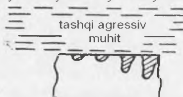
14-rasm, b ) mahalliy korroziya.
