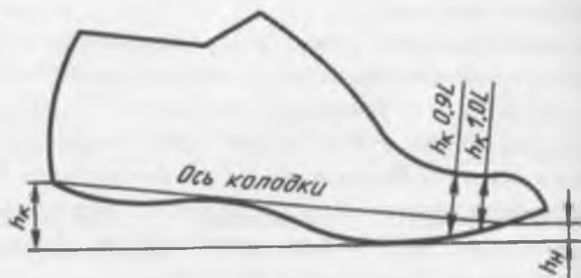
4.1-расм. Қолип тумшук қисми баландлигини ўлчаш
