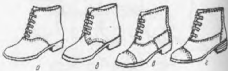
2.4-расм. Ботинка тановорлари конструкцияси:
