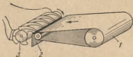
Рис. 94. Взаимодействие рабочих органов стригальной машины:
