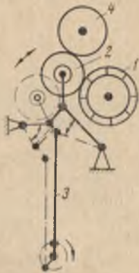
Рис. 34. Схема взаимодействия рабочих органов мездрильной машины ММ2-47 (пунктиром показано нерабочее положение):
