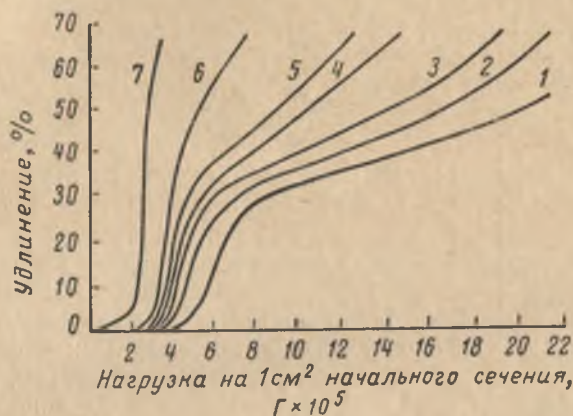
Рис. 101. Зависимость удлинения волоса от нагрузки при разной температуре воздуха (°C):
