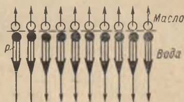
Рис. 38. Поверхностное натяжение двух несмешивающихся жидкостей (Р — результирующая равнодействующая)
