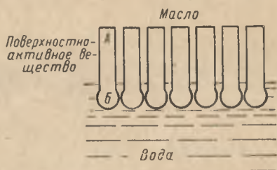
Рис. 39. Ориентация молекул поверхностно-активного вещества в пограничном слое (А — неполярный радикал; Б — активная группа)
