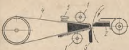
Рис. 98. Взаимодействие рабочих органов эпилировочной машины ЭМ2-550:
