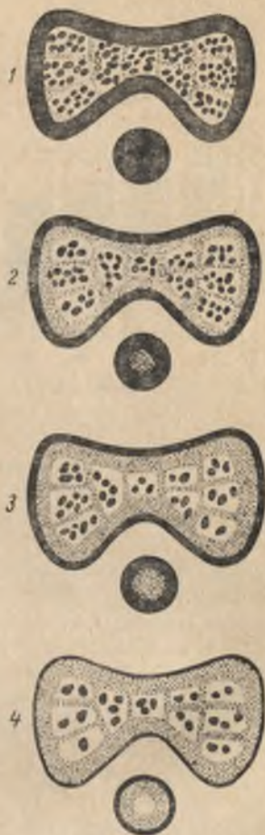
Рис. 69. Перехромирование волоса кролика при крашении по хромпиковой протраве; хромпика взято (г/л): 1 — 0,5; 2 — 2; 3 — 10; 4 — 20
