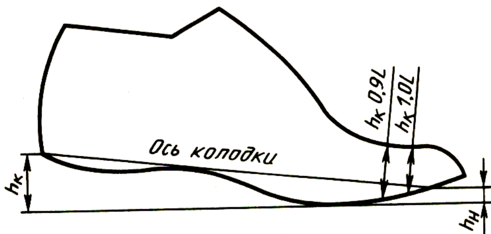
4.1-расм. Қолип тумшук қисми баландлигини ўлчаш
