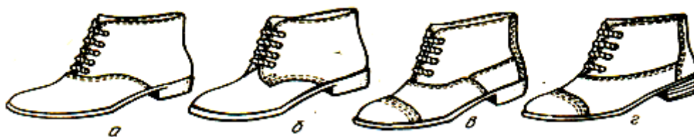
2.4-расм. Ботинка танаворлари конструкцияси:
