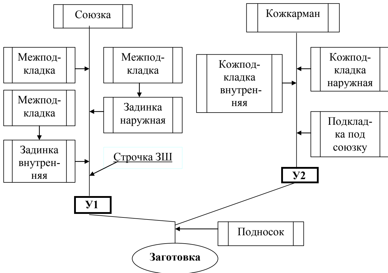
Рис. 1.1. Схема сборки заготовки
