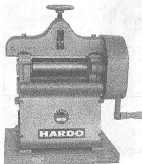
Рисунок 2.24. Приспособление для двоения деталей низа обуви Fenda фирмы Hardo (Германия)
