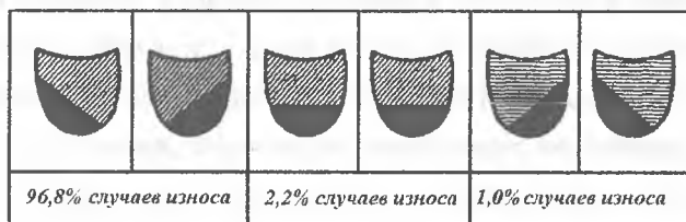
Рисунок 1.7. Топография износа резиновых набоек и нижней части каблуков (затушеваны места наибольшего износа)
