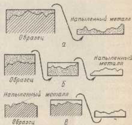
Рис. 75. Схемы получения реплик одноступенчатым (а), двухступенчатым (б) методом и методом предварительного оттенения (в)
