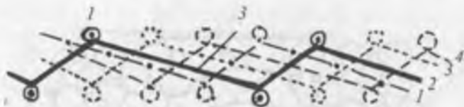
4.37.4-rasm. Bitta halqa qatori to'rtta to'liq bo'lmagan ribana o'rinishli ipdan shakllangan murakkab interlok to'qimaning grafik chizmasi.
