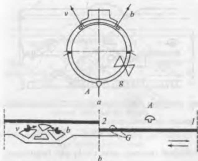
5.2-rasm. Aylana ignadonli paypoq to'quv avtomatining halqa hosil qilish a'zolarining joylashishi sxemasi.
