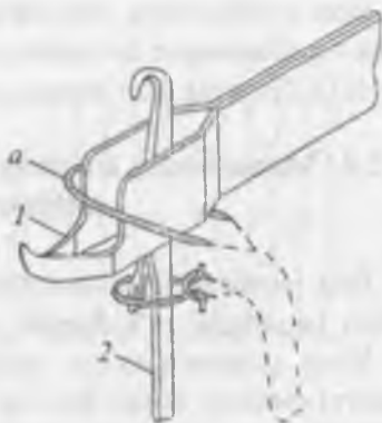
2.20-rasm. Uchinchi qator to'liqmas «a» halqalarni bort ilgaklaridan ignalarga ko'chirish jarayoni.
