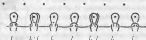
7.6a, b-rasm. JET-2F mashinasida yeng manjetlari halqalarini ko'chirish sxemasi: a — ko'chirishga qadar halqalarning holati; b — ko'chirishdan keyingi holati.
