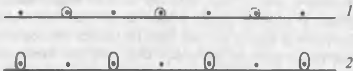
4.36-rasm. Hosilali suprem to'qimani to'qishdagi grafik chizmasi.
