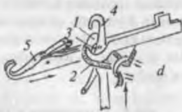
4.21g, d-rasm. Halqa ko'chirishda asosi «a» o'yiqli va ikki boshli juft tilchali ignalardagi halqalarni bir ignadon ignasidan ikkinchi ignadon ignasiga ko'chirish jarayoni.
