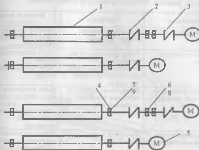
9.15- расм. УЧДМ машинасининг кинематик схемаси.
