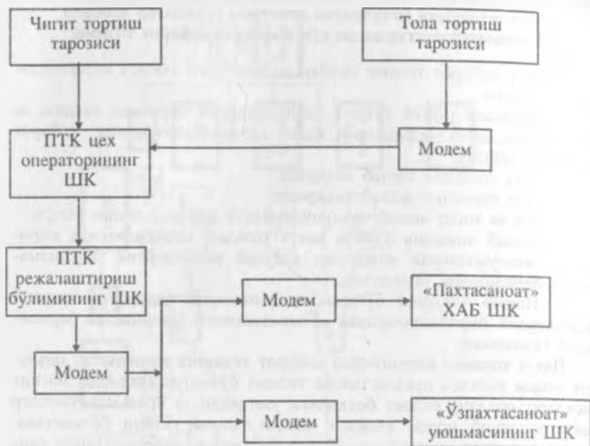
11.3- расм . Узулксиз технологик оқимда пахта маҳсулотлари тойларининг ва чигитини тортиш натижалари ҳисобини юритишнинг автоматлаштирилган тизими.
