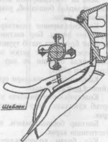
13.18- расм. Линтернинг аррали цилиндрни тўғри ўрнатилганлигини текширишда шаблон ҳолати.
