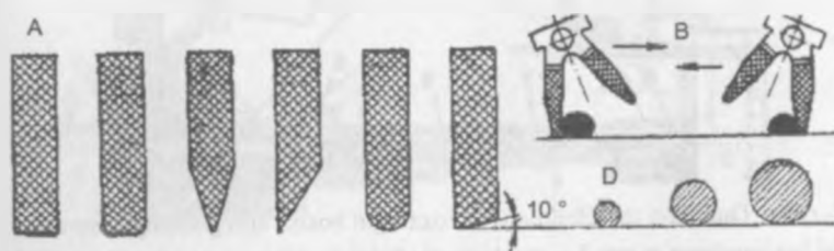
211- rasm Turli andoza yordamida gul bosishda ishlatiladigan raklyalar: A – bir tomonlama raklya, B – ikki tomonlama raklya; D – rolksimon raklya.
