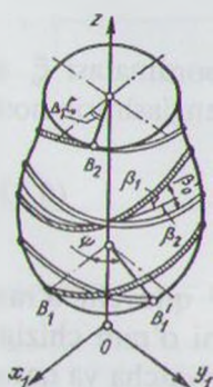
6.3-rasm. O'ramlarning kesishuv b_0 va siljish \psi burchaklari sxemasi.
