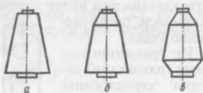
19-расм. Конуссимон ўрам турлари: а — бир конусли; б — икки конусли; в — уч конусли.
