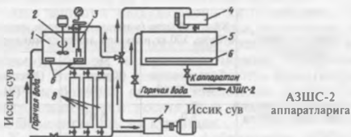
3-расм. Ивитиш эмульсиясини тайёрлаш учун ишлатиладиган эмульгатор тизими.
