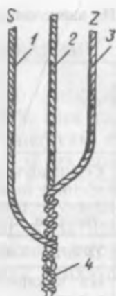
80-расм. Арматураланган, металлштирилган ипнинг тизими:
