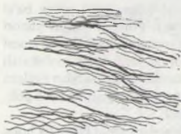
1.5-rasm. Pachkalar orqali o'tadigan makromolekula zanjirlarining sxematik tasviri
