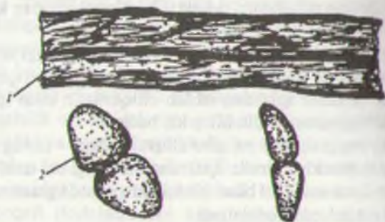
4.7-rasm. Bir-biriga yopishgan ikkita toladan iborat pilla ipi (1) va ko'ndalang kesim yuzasi (2).
