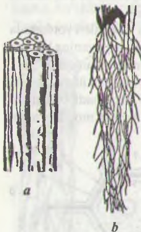
3.7-rasm. Texnik tolalarning to'rsimon tuzilishi.
