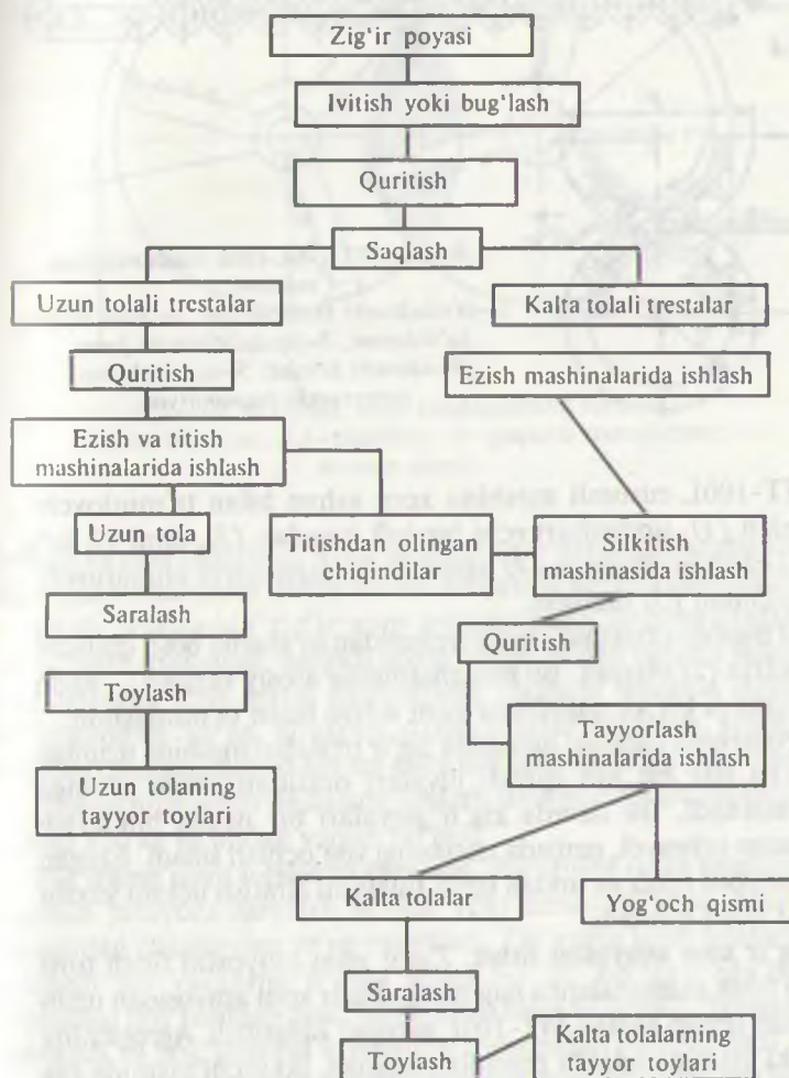
3.8-shakl. Zig'ir poyasiga dastlabki ishlov berish jarayonlarining tartibi.
