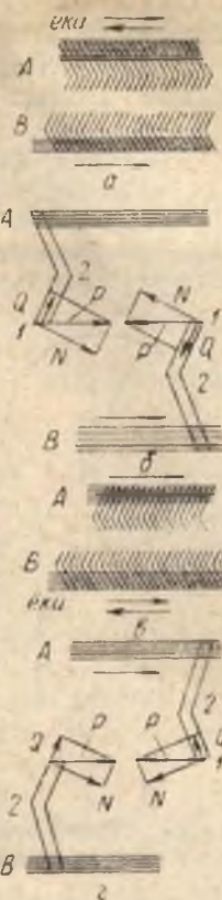
35- расм. Игналар гарнитура қопланган органларнинг узаро таъсирлашуви:
