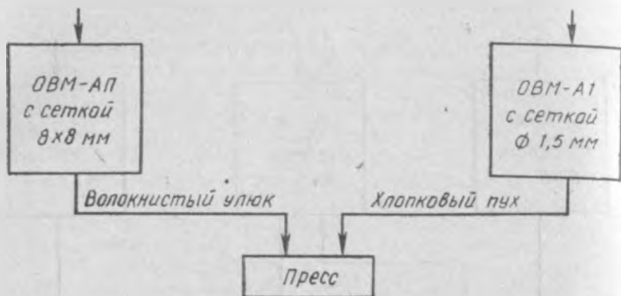
20. Схема технологического процесса переработки утилизируемых отходов на хлопкозаводах валичного джинирования.
