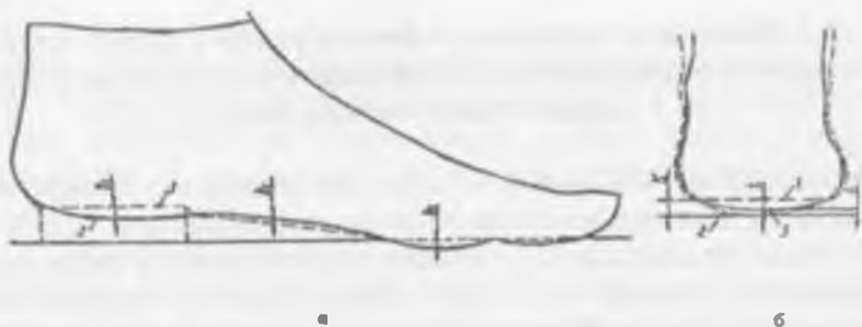
Рис. 2.12. Определение величин смятия мягких тканей стопы и корректировка следа 1 - положение равномерной опоры на плоское основание; 2 - безопорное положение; 3 - положение равномерной опоры на мягкое основание
