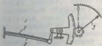
12-расм. Биметалл термометр: 1—2 — биметалл пластинкалар; 3 — кўрсаткич.
