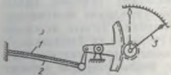
12-расм. Биметалл термометр: 1—2 — биметалл пластинкалар; 3 — кўрсаткич.
