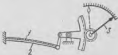
14-рasm. Биметалл термометр: 1, 2— биметалл пластинкалар; — 3 кўрсатувчи стрелка.
