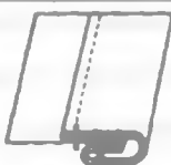
Рисунок 9.58. Обработка краев детали вдвое сложенной бейкой
