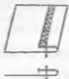
Рисунок 9.46. Шов в подгибку с обметанным срезом
