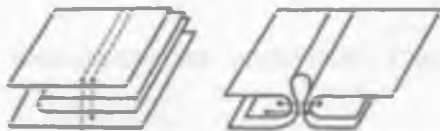
Рисунок 9.69. Стачной шов с кантом при выполнении двумя строчками: а - соединение деталей с предварительным притачиванием канта к одной из деталей; б - шов в готовом виде
