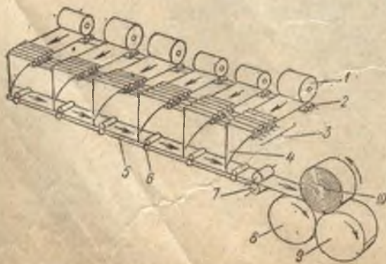
63- расм Холст чўзиш машинасининг схемаси.
