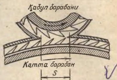
40- расм. Толаларнинг қабул барабанидан катта барабанга ўтиши.
