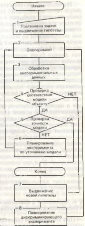
Рис. 6. Структурная схема алгоритма составления математической модели по экспериментальным данным.
