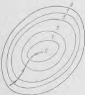
Рис. 21. Поиск наименьшего значения функции методом градиентного спуска.
