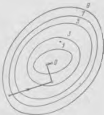
Рис. 22. Поиск наименьшего значения функции методом наискорейшего спуска.
