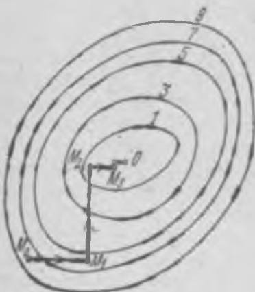
Рис. 20. Поиск наименьшего значения функции методом покоординатного спуска.
