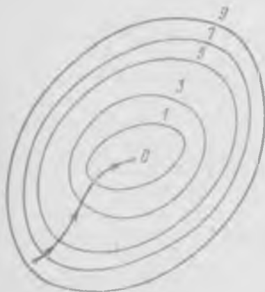
Рис. 21. Поиск наименьшего значения функции методом градиентного спуска.
