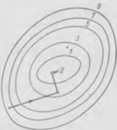
Рис. 22. Поиск наименьшего значения функции методом наискорейшего спуска.
