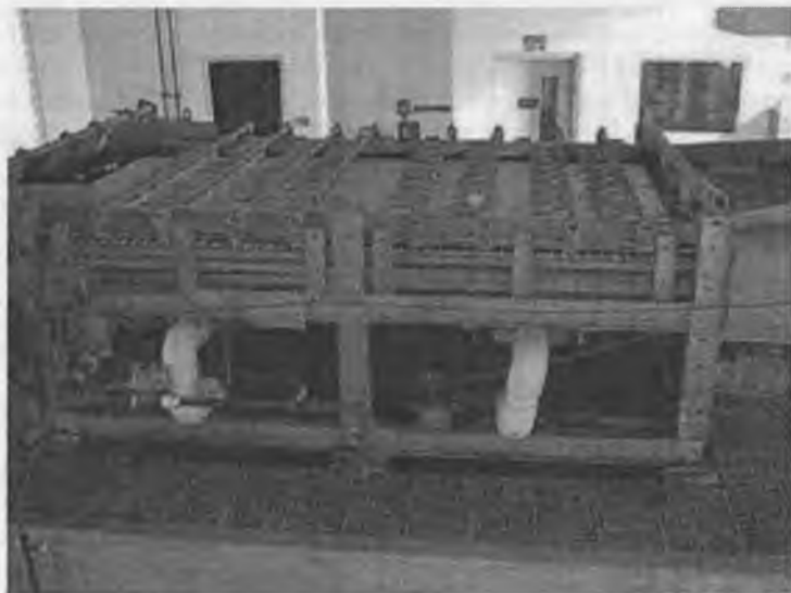
83-rasm. Tasmali gravitatsion zichlashtirgich rasmi.
