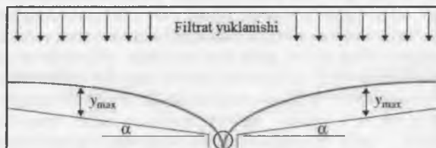
101-rasm. Poligon drenaj tizimining sxemasi.
