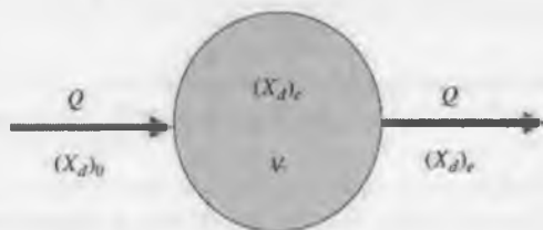
85-rasm. Uzlüksiz oqimli to'liq aralashtiruvchi aerob avtoklav sxemasi.
