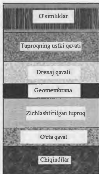
102-rasm. RCRA D. bandida qabul qilingan poligonni yopish tizimi namunaviy sxemasi.
