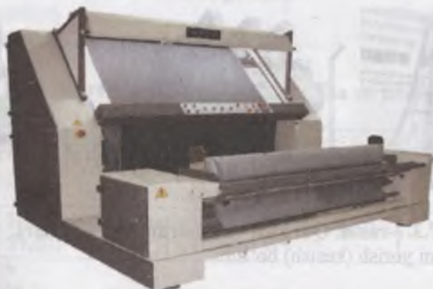
7.3.5-rasm. Yuqori tezlikda ishlaydigan materialning sifati va jipsligini tekshirish qurilmasi.
