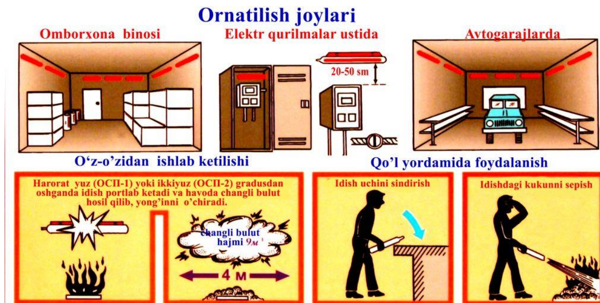
10.1- rasm. Kukunli o'zi ishlab ketuvchi o't ochirgichlarni o'rnatish joylari va ishlatilishi
