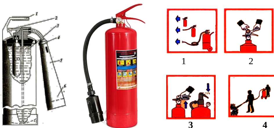
10.8-rasm. OVP-10 markali o't o'chirgichlar va ulardan foydalanish tartibi 1-tutgich; 2-dastak; 3-ko'pik hosil qiluvchi aralashma; 4-purkagich; 5-karnaysimon quvurcha; 6-metall to'r.
