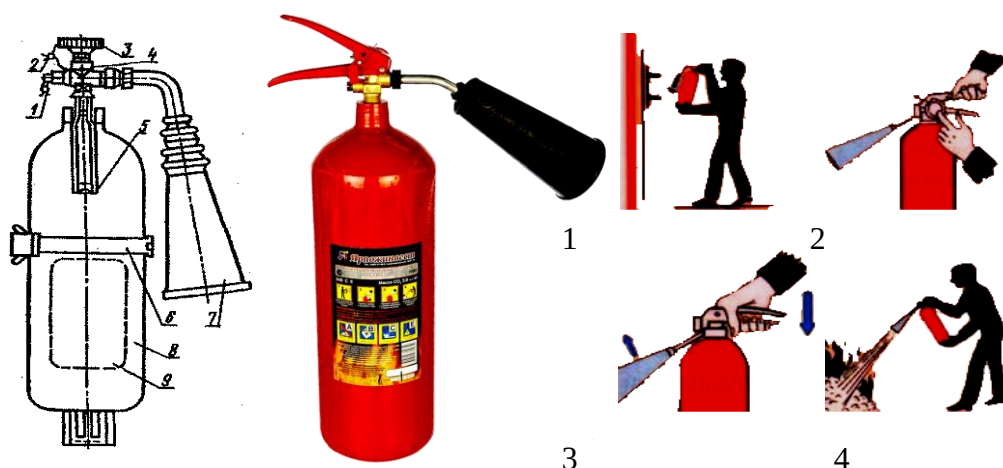
10.9-rasm. Korbonat angidridli o't o'chirigich va undan foydalanish tartibi 1-saqlagichli membrana plombasi; 2-zaryad plombasi; 3-maxovik; 4-ventil tomba; 5-ushlagich; 6-kronshteyn tombasi bilan; 7-qor hosil qilib beruvchi nay; 8-ballon; 9-yorliq joyi.
