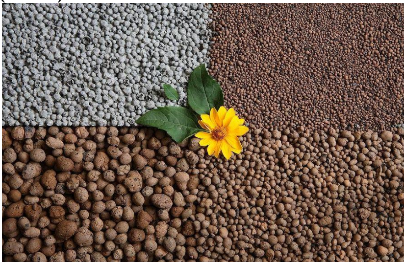
47-rasm. Yoqilg'i kuli va toshqollaridan g'ovak to'ldirgichlar.
