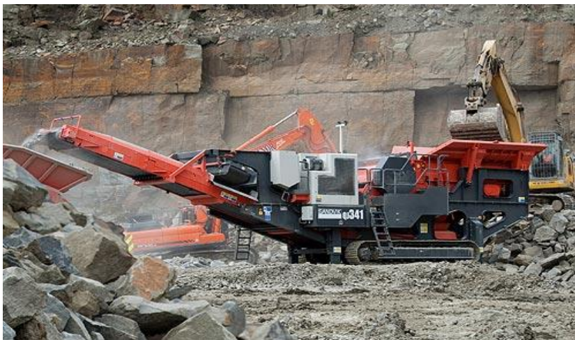
49-rasm. Chaqiq tosh, shag‘al, qum, gil va boshqa foydali qurilish materiallari tayyorlash jarayoni.
